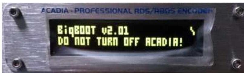
Se, por algum motivo, você utilizar um arquivo corrompido, inválido ou acontecer uma falha durante a atualização, o equipamento exibirá uma mensagem de erro por alguns segundos e irá reiniciar automaticamente, utilizando a versão de firmware antiga.
